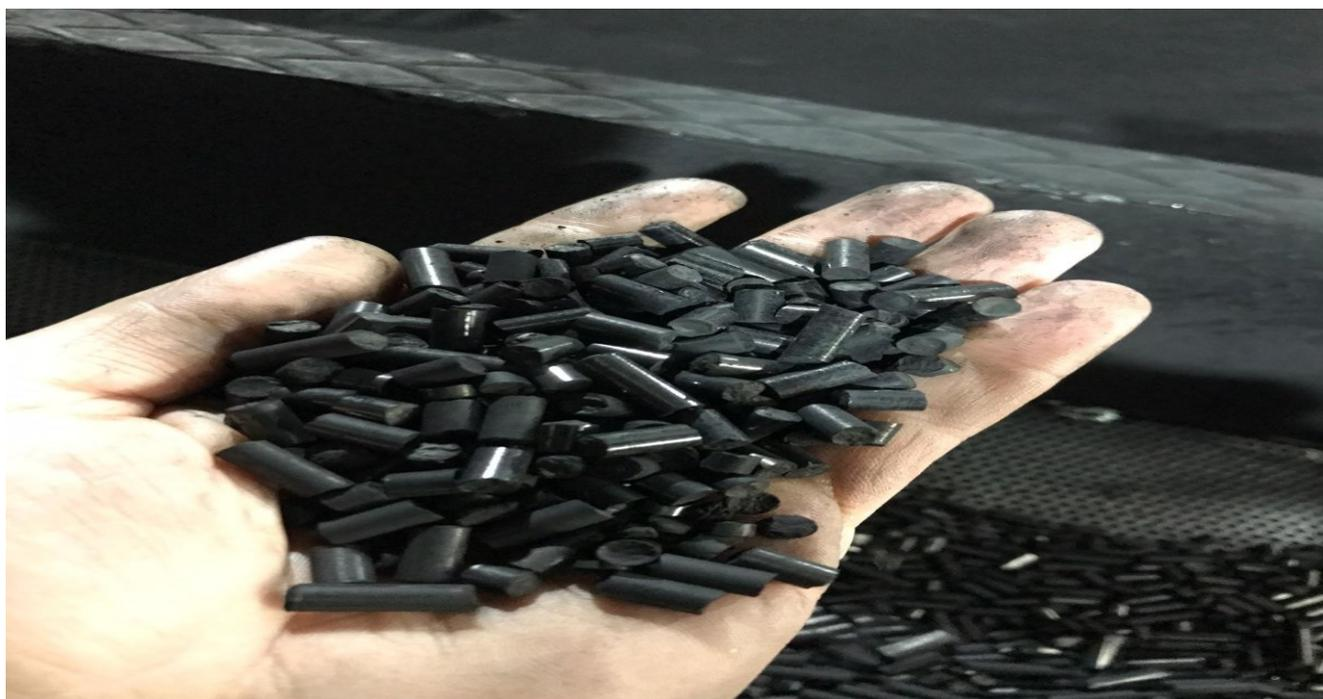
Os pellets pretos são produzidos a partir de biomassa residual com alto teor de lignina.. Não contêm quaisquer aditivos. O material é seco e prensado, da mesma forma que os pellets brancos, em pequenos pellets cilíndricos.
