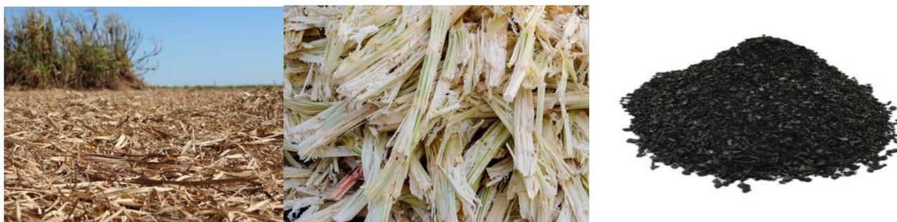
Os resultados do biochar produzido via pirólise lenta da palha e do bagaço da cana-de-açúcar em temperaturas entre 300 e 400 °C demonstram melhorias em relação aos valores obtidos da biomassa original do Cana-de-açúcar. Os rendimentos do biochar variaram entre 30% e 40%, com alto teor de carbono fixo, apresentando o maior valor em  $79 \pm [2,51]\%$ .
